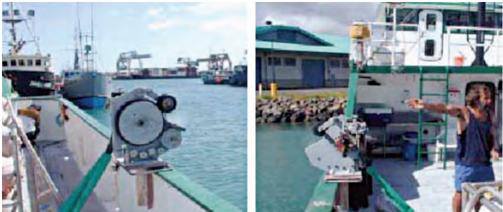
Figura 7. Configuración de la banda en un palangrero con máquina de calado.
