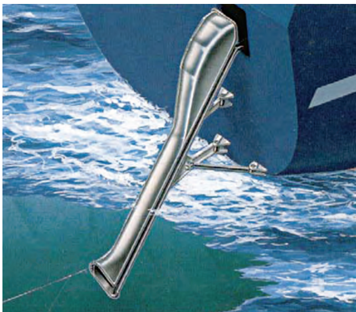
Figura 8. Tubo de calado diseñado por Mustad disponible en el mercado.
